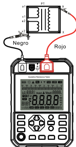
Fig. 10.2.1 Conexión de prueba
