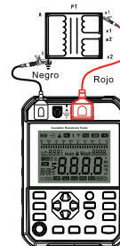
Fig. 10.2.2 Conexión de prueba
